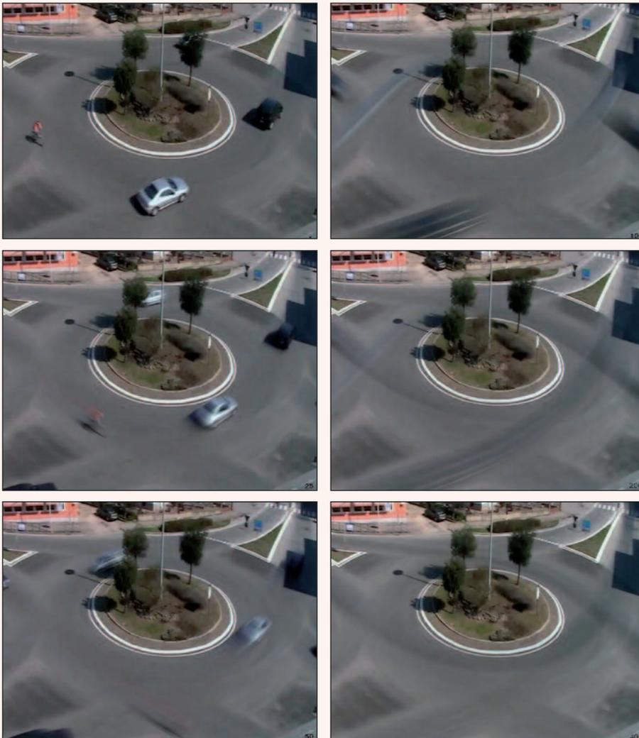
Figure 7A, 7B, 7C, 7D, 7E e 7F - L'adattamento del modello di sfondo nei fotogrammi 1, 25, 50, 100, 200 e 400 (0,04 s per fotogramma)
