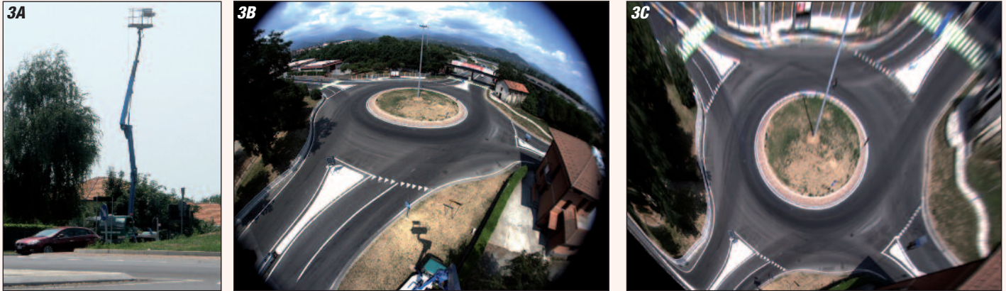
Figure 3A, 3B e 3C - La postazione di rilevamento (3A) con la relativa vista (3B) e l'immagine elaborata della rotondina (3C)
